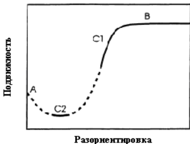
Рис. 3.4. Схема возможных вариаций подвижности произвольных МУГ от разориентировки
