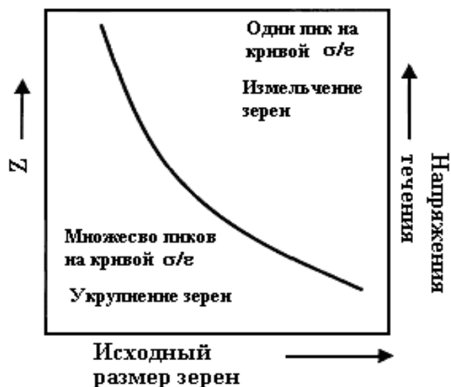
Рис. 7.5. Условия динамической рекристаллизации с одним пиком и с осцилляцией напряжений течения
