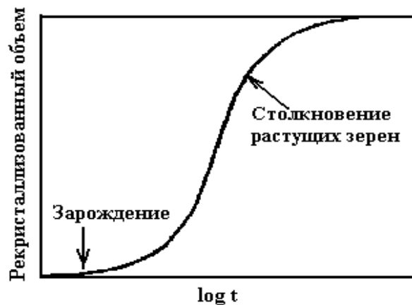
Рис. 5.1. Типичная кинетическая кривая рекристаллизации в ходе изотермического отжига
