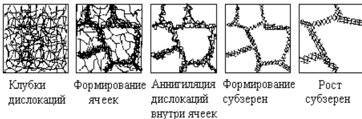
Рис. 4.1. Стадии возврата в деформированном материале
